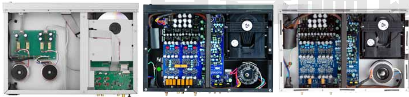
比較新舊兩代，就可發現8200CD脫胎換骨的轉變。前代8000CD（左圖）的機箱內部非常清爽，電路板只有小塊。8200CD（右圖）的線路則密密麻麻塞滿整個機箱。至於內建前級的8200CDQ（中圖），目前與8200CD同樣小幅改款為V12E版本。
