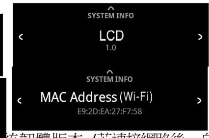
提供與顯示目前機器的相關訊息。包含目前 BluOS 串流系統韌體版本 (若連接網路後，自動偵測有 UPGRADE 升級的訊息，可按面板的 ENTER 鍵進行更新)，MCU(主機板微控制器)版本，LCD(顯示螢幕)版本，連接網路的 IP 位址、MAC 位址 (區域網路位址，有線與 WI-FI 無線)等，以供參考。
