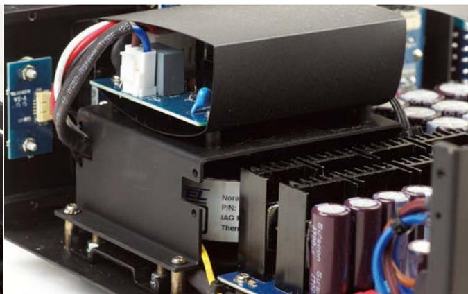
▲左：與8300CD一樣，M-DAC+是以即時運算效能達500MIPS，可支援最高DSD 128檔案轉碼的XMOS 32bit 8U6C5為核心，佐以獨立數位時鐘，獨立配電的獨立數位接收電路板。右：M-DAC+比起前作M-DAC最大的性能提升來自於電源部採用與8300CD同規格的環形變壓器。
