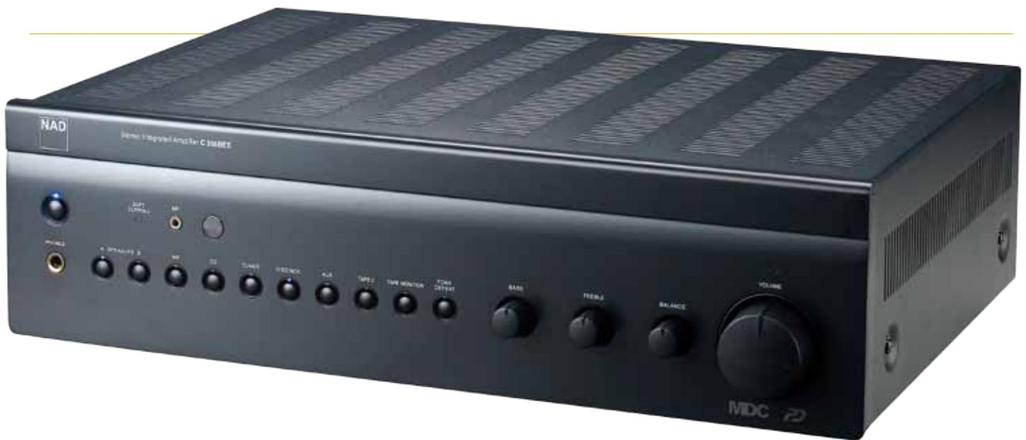
●型式：內建DAC的綜合擴大機●額定功率：大於80瓦×2（8歐姆與4歐姆）●總諧波失真：0.009%（1kHz,4歐姆,45瓦）●切割功率：90瓦以上●IHF動態功率：8歐姆145瓦、4歐姆200瓦、2歐姆290瓦●訊噪比：110 dB●頻率響應：10Hz~65kHz(-3dB) ●MDC DAC模組對應取樣率：32kHz~96kHz●輸入端子：Toslink光纖輸入×1、USB Type B×1、二聲道類比輸入×7、後級輸入×1●輸出端子：喇叭端子×2、前級輸出×2、Tape Out×2●控制端子：RS 232、Trigger與IR●尺寸（寬×高×深）：435×130.86×337mm●重量：9.8公斤●參考售價：45,000元。
