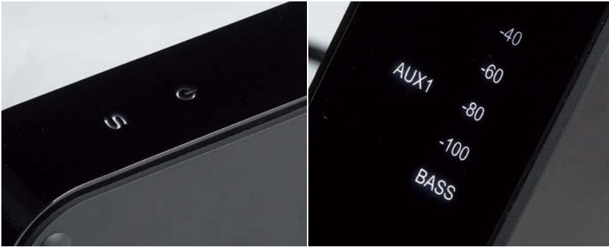
▲左：D 3020開關與訊源選擇採用無按鍵LED觸控介面，充滿科技感。 右：前方LED顯示介面可顯示訊源、音量與「Bass EQ」狀態。
