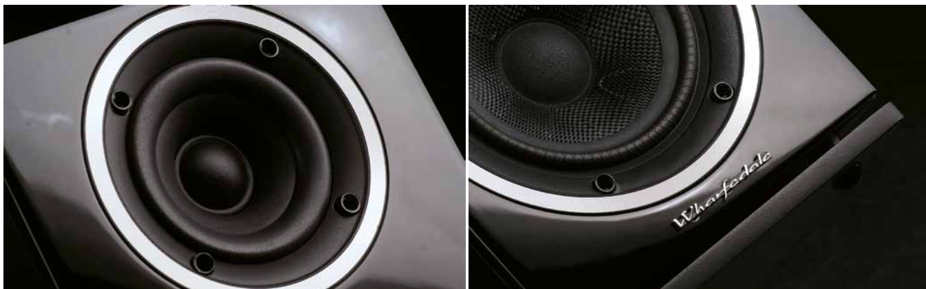
▲左：高音採用直徑2.5 mm的軟膜凸盆單體，並且將單體裝置在看似音盆外觀的短號角內，讓高音發聲位置往音箱內縮，使得與中音單體發音的「時序」更為整齊。 右：中低音部分則是平價揚聲器較為罕見的Kevlar功夫龍纖維材質音盆單體，並特別設計了鑽石壓紋處理的懸邊結構，在音盆運動時能更有效率。
