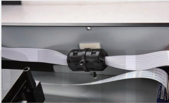
在C 538播放機內部、電源與主機版之間的排線上，還特別加入磁環來抑制EMI電磁波干擾，從小地方就可以看得出來C 538對音質的重視。
