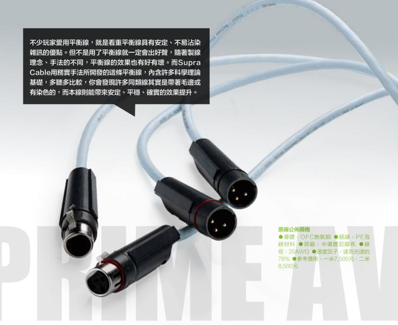
來,Supra Cable的研究發現,訊號線必須容抗越小越好,才能避免訊號在傳輸過程中有任何延遲,所以本線採用特殊的PE泡棉材質來絕緣,將容抗降低到僅有45 Pf/m而已,降低材料本身對傳輸的影響。屏蔽部份,採用100%半導體尼龍布材質,具有絕佳的雜訊隔離效果,能避免麥克風效應,同時提高線材彎曲時的耐受力。
