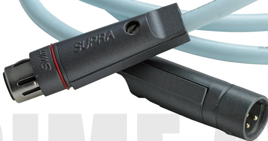
「集膚效應」，使得高頻訊號附著在導體表層，此時高頻與中低頻的所經過的導體阻抗不相同，會導致高音衰減、相位失真的狀況。為解決這個問題，各家線材廠都有自己的獨門秘方。本線就是採用原廠獨家EFF（Equalized Frequency Flow Technique）全頻段傳輸技術，顧名思義它是一種可使全頻段訊號均衡傳遞的同軸技術。首先採用不導電的聚乙烯塑料做為導體軸心，再用線徑0.2mm的無氧銅鍍銀導體旋轉絞繞在塑料芯上，電流能夠均衡分佈在導體之中，以優化高頻段訊號傳遞，達到更平衡的音質表現。
