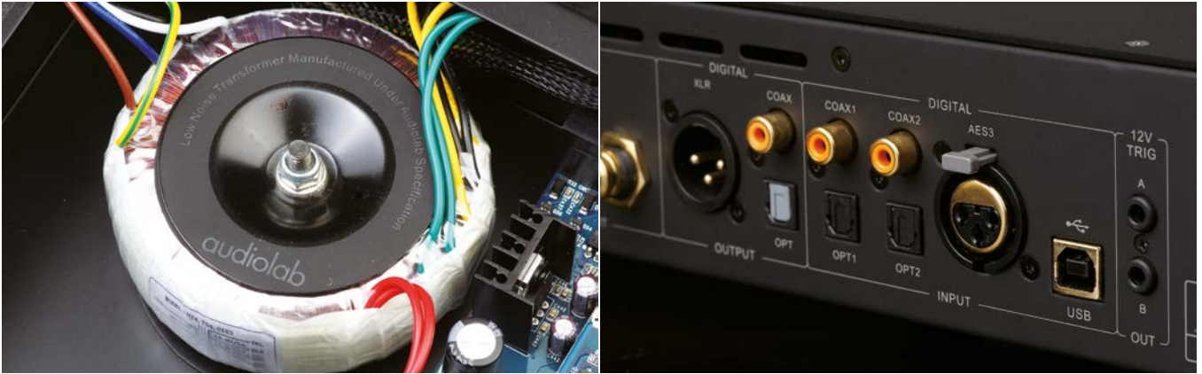
▲左：Audiolab以訂製的環形變壓器與總容量達250,000 \mu F的濾波電容陣列作純淨供電。右：可作CD、DAC、USB DAC使用的8300CD，取消了8200CDQ的前級類比輸入界面，新增了數位平衡輸入、輸出端子。
