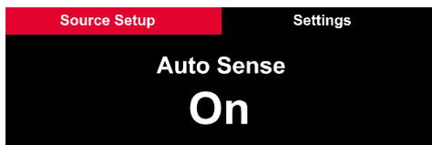
“Auto Sense 自動感應”設定於 on 時，於機器待時，只要使用其網路 APP、按壓遙控器或操作機器面板就能直接再開機。
