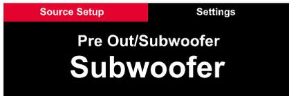
C388/C368 連接主動式超低音時，請設定選擇 Subwoofer，喇叭連接於 C388 /C368 的 A/B 組喇叭端子；Filters 請同時設定於“High Pass”。
