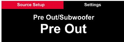
C388/C368 可當作前級，連接後級功率擴大機，請設定選擇 Pre Out，C388 A/B 組喇叭端子無作用，喇叭需連接於後級功率擴大機。
