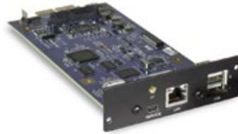
←這就是MDC DD-BluOS網路串流模組，除了有網路端子，插上Wi-Fi Dongle也可連上無線網路。USB端子則可連接隨身碟或外接硬碟，播放內中儲存的音樂檔案。
