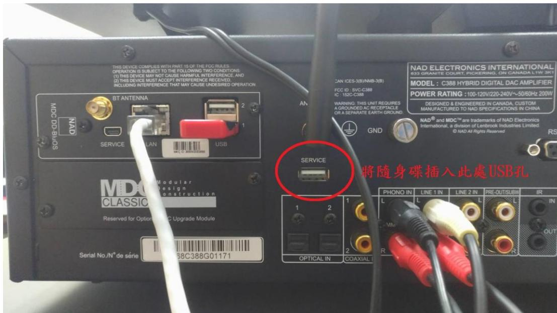
3. 打開機背之電源開關，即開始自動讀取並更新，100% 並顯示 MAIN Upgrade Done，即代表完成更新。待螢幕轉暗並沒有後續動作後，請再度打開前面板電源。
